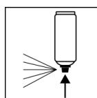
Nach Beenden des Lackievorganges Dose umdrehen und 3 - 5 Sekunden sprühen um das Ventil zu reinigen.
